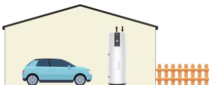
Instalación en una habitación sin calefacción >15m 2
