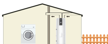
Instalación con 2 conductos al exterior
